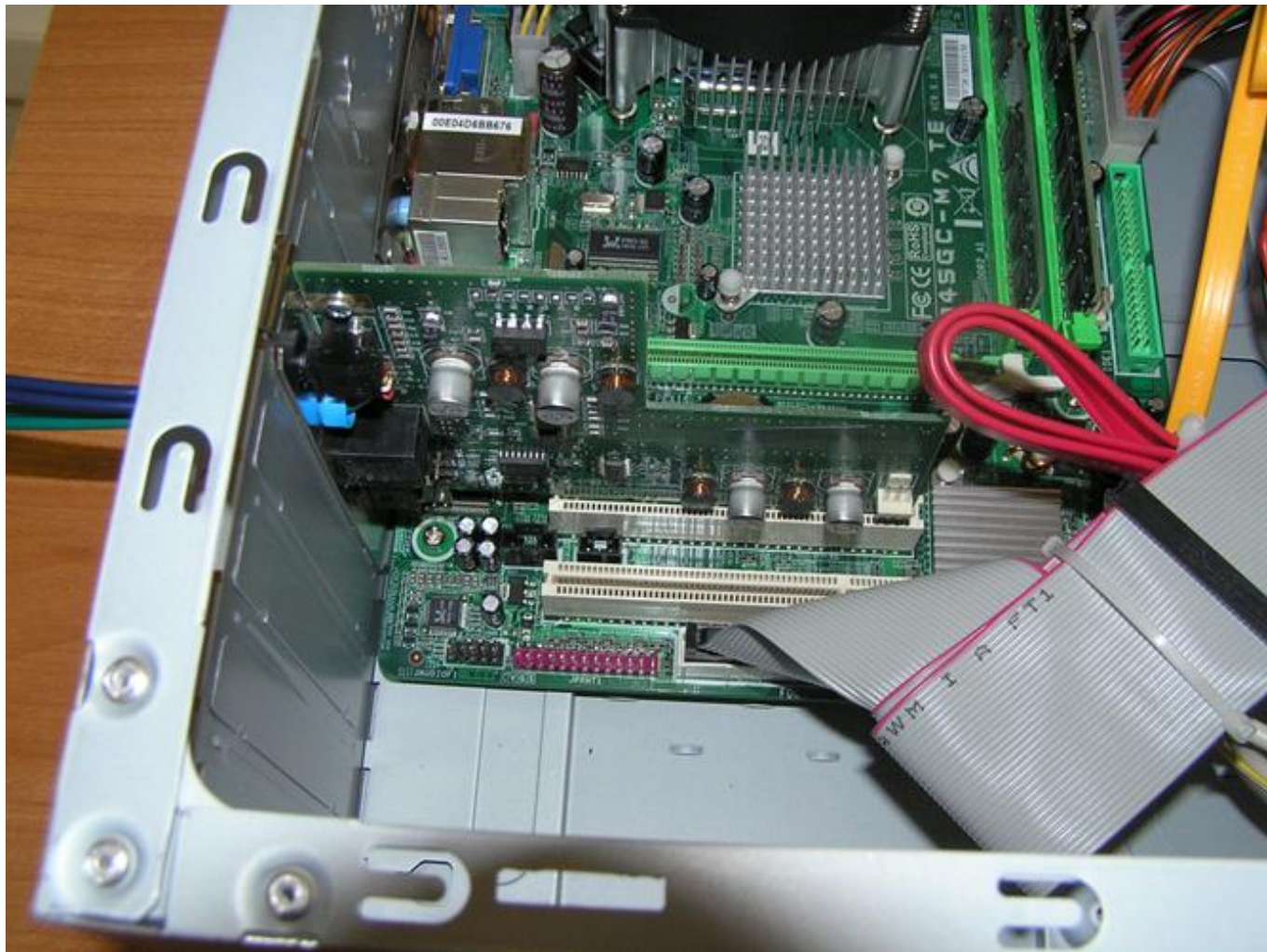
Шаг 1. Установка Линго карты (PCI) в ПК
